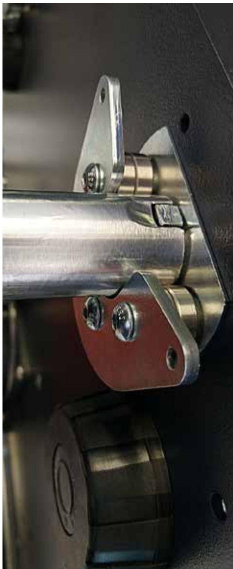
Antrieb über Bolzen-Nute-Verbindung
